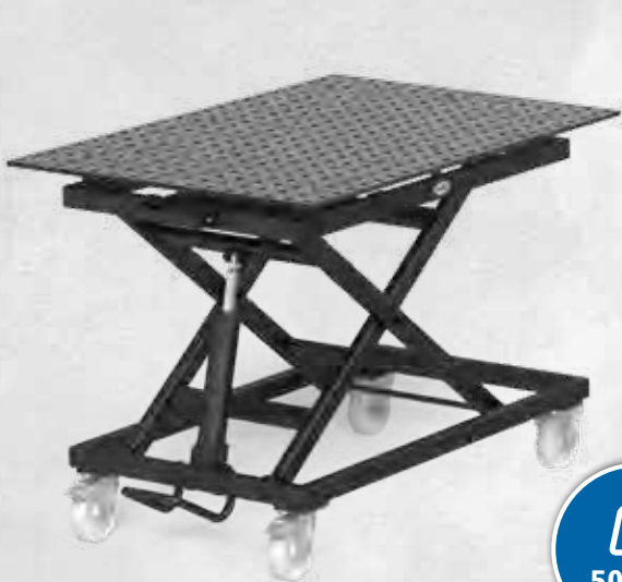
Mobilní zvedací stůl 500 kg: Rozměry (D x Š): cca. 1115 x 630 mm, Hmotnost (bez desky): cca. 65 kg Pracovní výška od cca. 700 do 1000 mm
