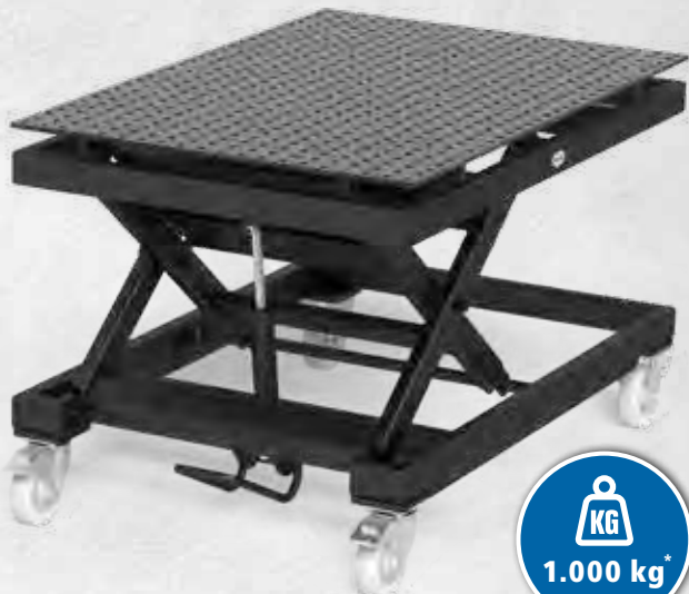
Mobilní zvedací stůl 1000 kg: Rozměry (D x Š): cca. 1490 x 990 mm, Hmotnost (bez desky): cca. 200 kg Pracovní výška od cca. 700 do 1000 mm
