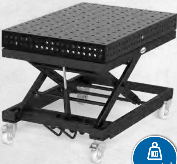
Mobilní zvedací stůl 1200 kg: Rozměry (D x Š): cca. 1490 x 990 mm, Hmotnost (bez desky): cca. 210 kg System 16: Pracovní výška od cca. 700 do 1000 mm System 22: Pracovní výška od cca. 750 do 1050 mm System 28: Pracovní výška od cca. 800 do 1100 mm
